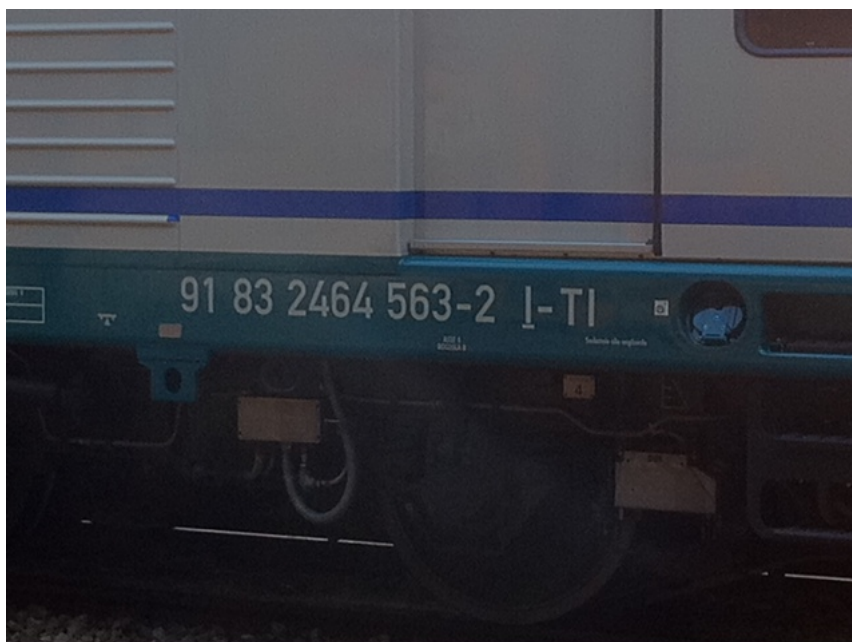
Mezzo di trazione Trenitalia con cabina di guida che riporta le cifre dalla 6ª alla 11ª pari al gruppo del rotabile ed al numero di serie progressivo del mezzo di trazione (E 464-563).
